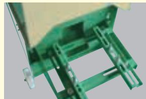
写真② 後方残土排出口
