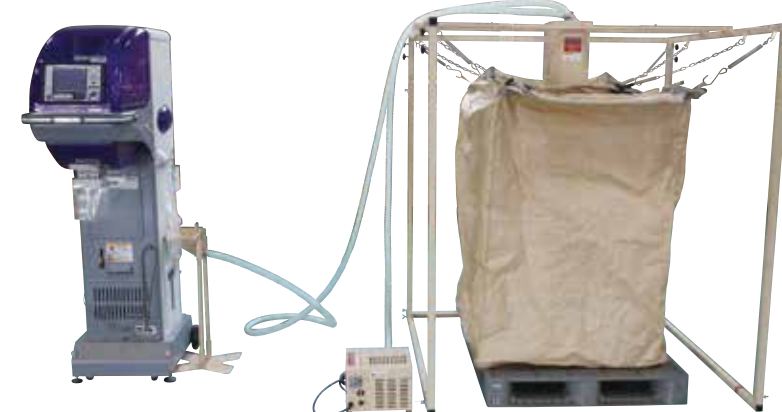
〈使用例〉選別機+吸太郎+フレコンバックスタンド+フレコン袋
