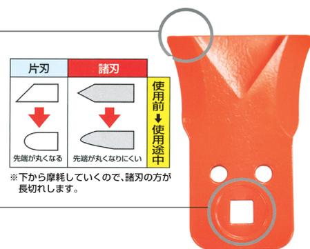
※下から摩耗していくので、諸刃の方が長切れします。
