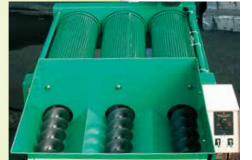
送りラセンによって張込み量を調整できます。
