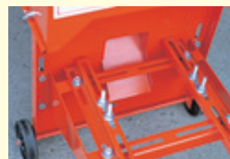
写真② 後方残土排出口
